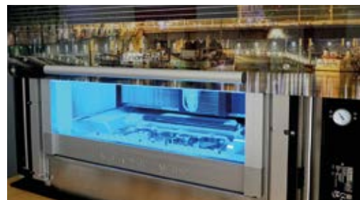
Die digitale Fertigung von Dentalprodukten erfolgt mittels CAD/CAM-Anlage. Foto: Nordic CAMPUS
