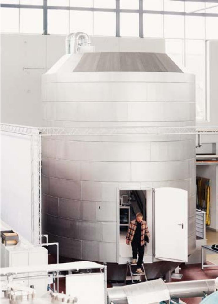
In Bremen steht ein Modell eines Mars-Laborgebäudes, um Abläufe praxisnah zu erforschen (Bild links). Marc Avila neben dem „GraviTower Bremen Pro“: Darin wird ein Experimentträger auf die für Schwerelosigkeit erforderliche Geschwindigkeit gebracht und nach der Freifallphase wieder eingefangen.
