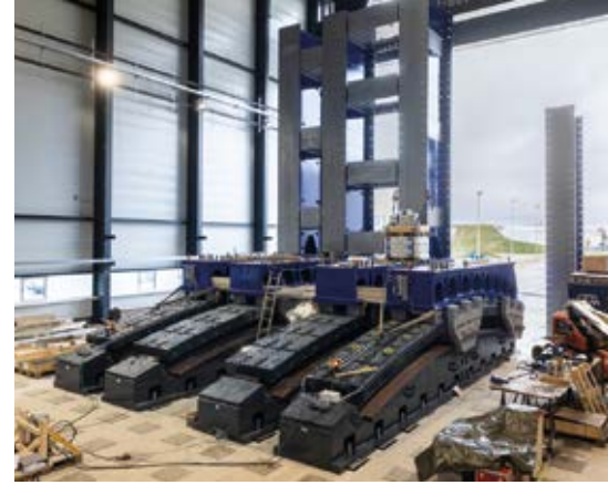
Die Rotorblätter werden in Bremerhaven buchstäblich auf Biegen und Brechen getestet.
